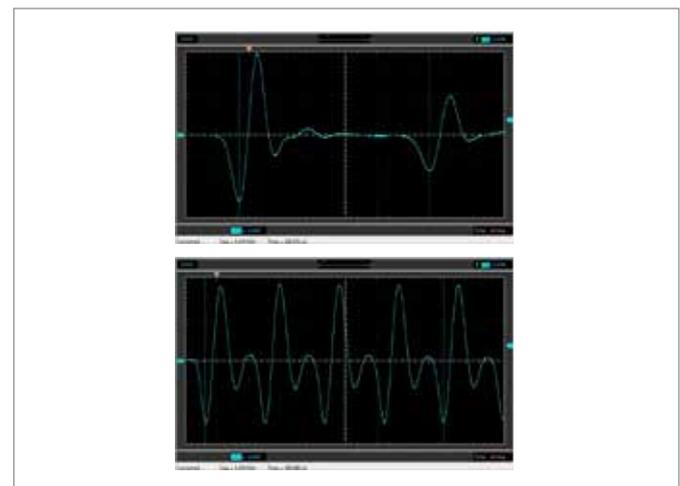
Fig. 3: Propagación de un impulso de sonido (arriba: barra de PVC, 200 mm, abajo: barra de vidrio, 200 mm), señal en el extremo de la excitación (cian)
