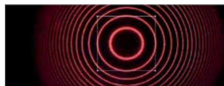
Fig. 2: Ausencia de campo magnético externo: Observación de los anillos de interferencia de la línea roja de cadmio creada por el interferómetro de Fabry-Pérot. A manera de orientación, el segundo anillo de interferencia desde el centro está marcado con un recuadro.
