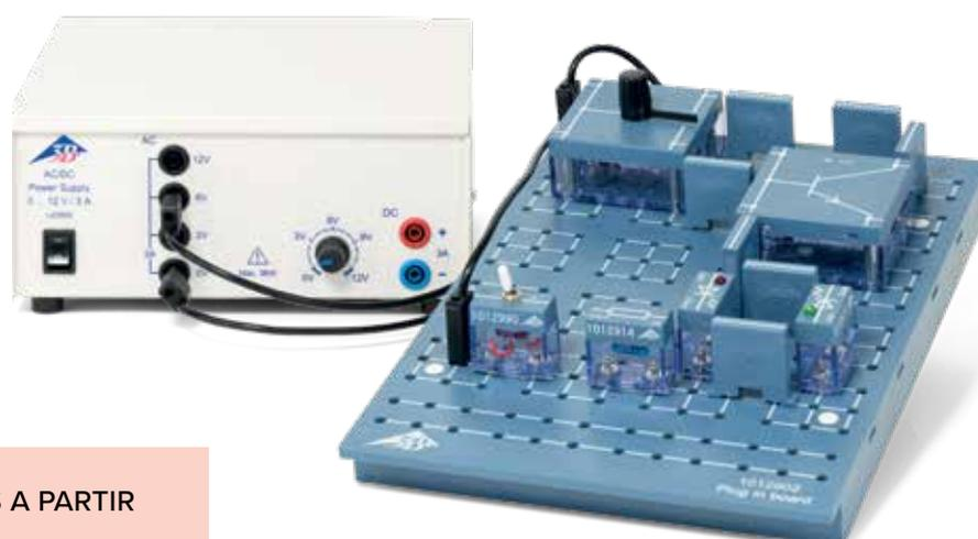
Comprobación del flujo de corriente en un transistor
