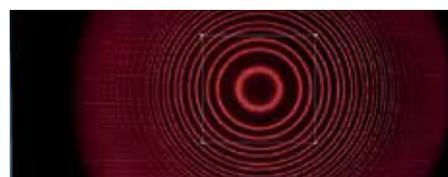
Fig. 3: Efecto longitudinal de Zeeman: Observación de la división doble de la línea roja del cadmio en un campo magnético externo.
