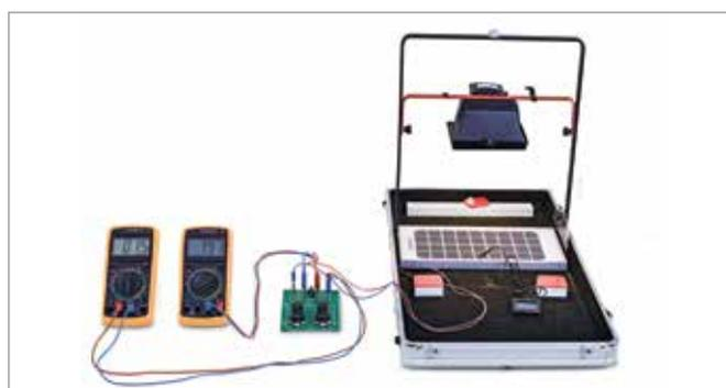
Dependencia de la temperatura de la potencia de módulos solares
