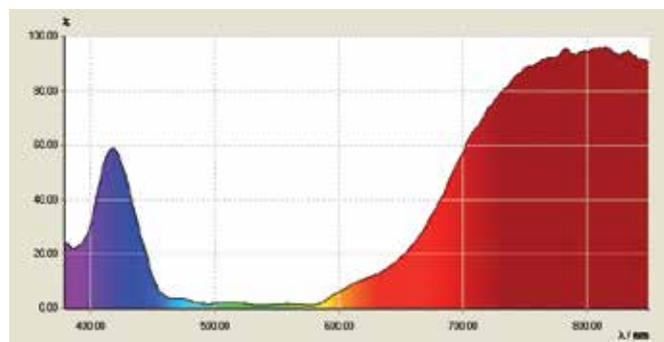
Fig. 4: Espectro de transmisión de una solución de permanganato de potasio
