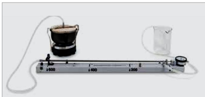
Fig. 3: Montaje con generador de vapor
