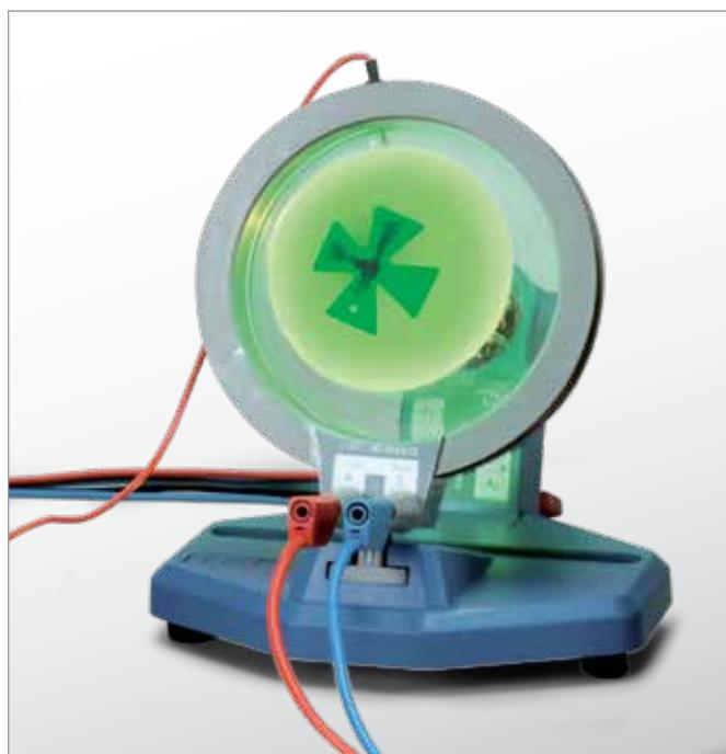
Fig. 2: Rotação da sombra de elétrons por meio do desvio de elétrons num campo magnético axial
