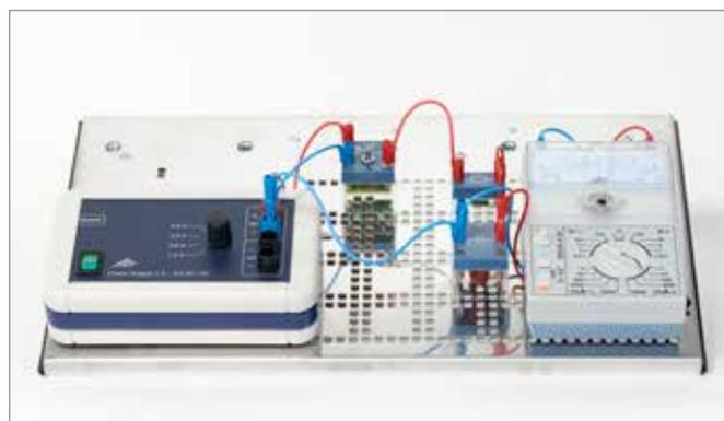
Carga e descarga de um capacitor (tensão)
