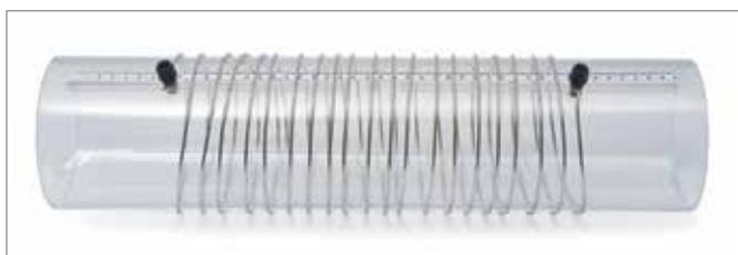
Fig. 1: Bobina com densidade de espiras variável
