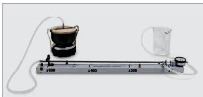
Fig. 3: Montagem com gerador de vapor
