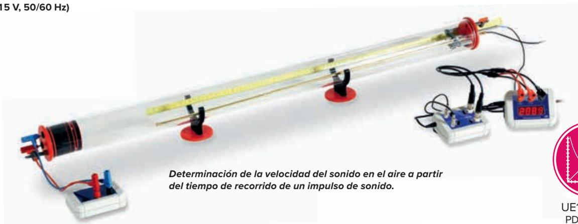
*Determinación de la velocidad del sonido en el aire a partir del tiempo de recorrido de un impulso de sonido.*
