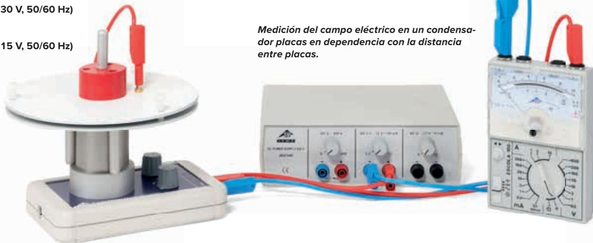
*Medición del campo eléctrico en un condensador placas en dependencia con la distancia entre placas.*
