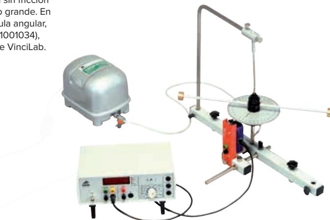
Medición de la duración del período y determinación del momento de inercia
