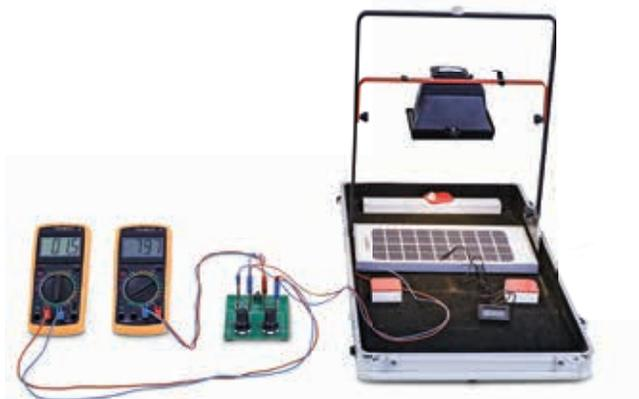
*Dependencia de la temperatura de la potencia de módulos solares*
