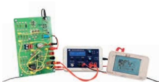
Registro de la curva de resonancia de un circuito oscilante RLC en serie
