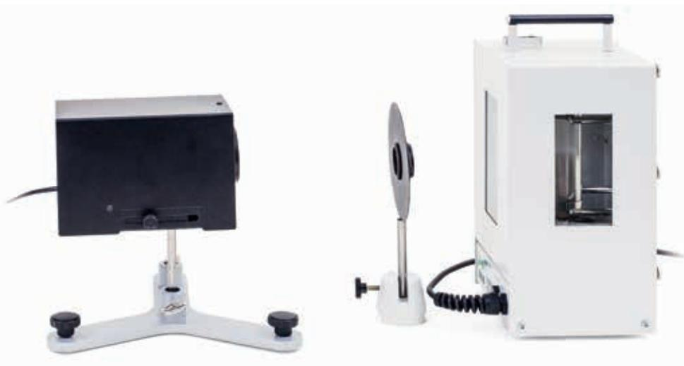
**Montaje experimental para la irradiación del tubo de fluorescencia del sodio con luz blanca focalizada**
