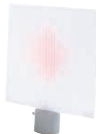
*Generación de la interferencia de dos rayos con un biprisma de Fresnel*
