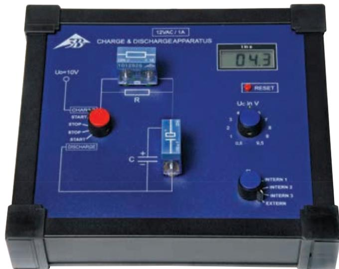
Medición en un par de RC externo
