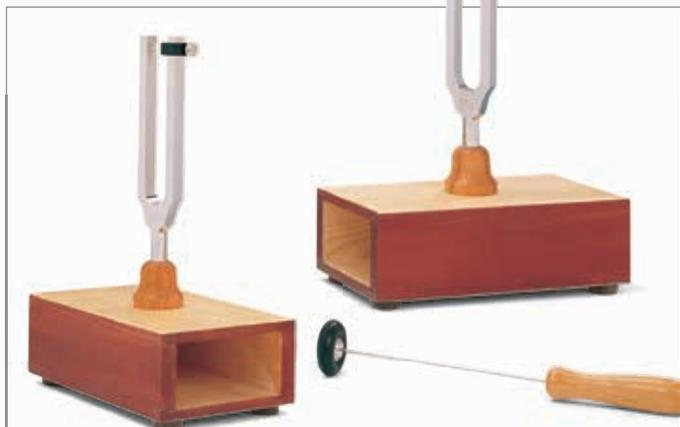
**Par de diapasones de 440 Hz sobre cajas de resonancia**
